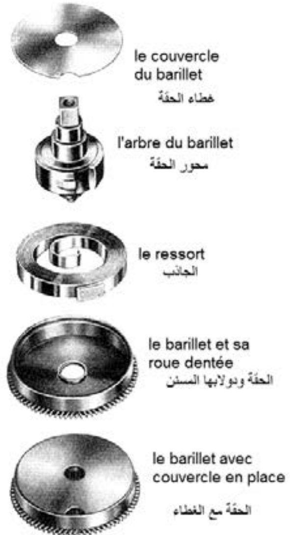
Fig. 13 - Le barillet et ses éléments.
