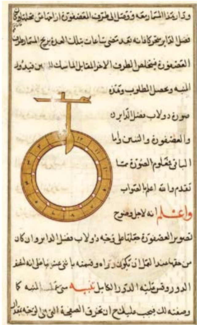
Fig. 11 - la détente du réveil-matin, d'après le traité de Taqīal-Dīn.
